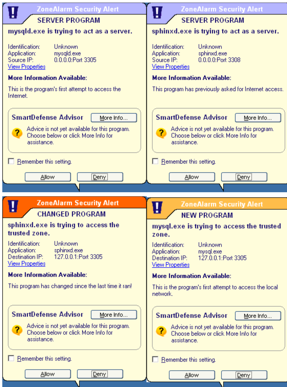
Рисунок 45. Примеры запроса файрвола на блокирование/разблокирование программы.
